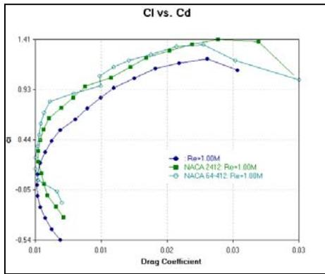
Figure 3. Lift Coefficient Versus Drag Coefficient
